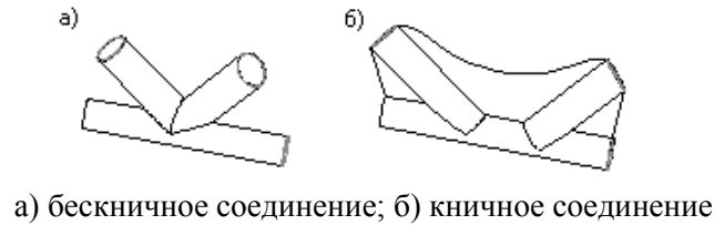
Рисунок 7 – Варианты узлов ферменных опор
