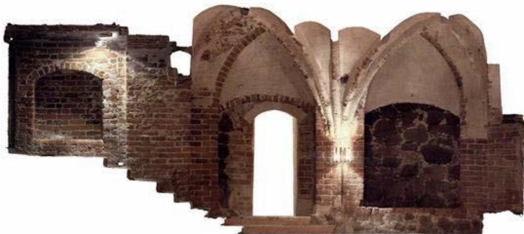
Сурет 5 — Түсі туралы суретке түсірілген деректердің қосымшалары бар тарихи ғимараттың лазерлік сканерлеу нүктелерінің бұлт үзіндісі. (Көзі COBIM Inventory BIM)
