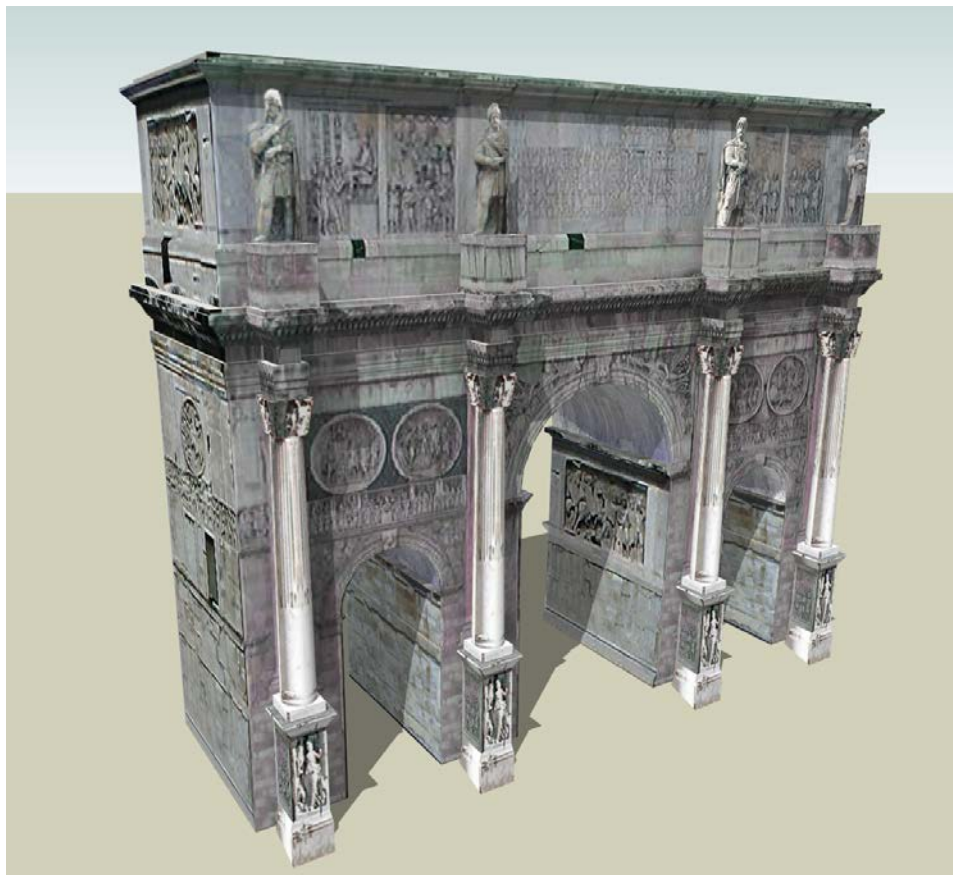
Рисунок 8 — Высокоточная ЭМИСО уровня 3, фрагмент объекта моделирования в электронной модели с высокоточным (высоким) уровнем геометрической точности моделирования
