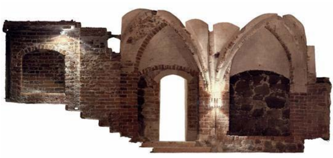
Рисунок 5 — Выдержка облака точек лазерного сканирования исторического здания, с приложенными сфотографированными данными о цвете. (Источник COBIM Inventory BIM)
