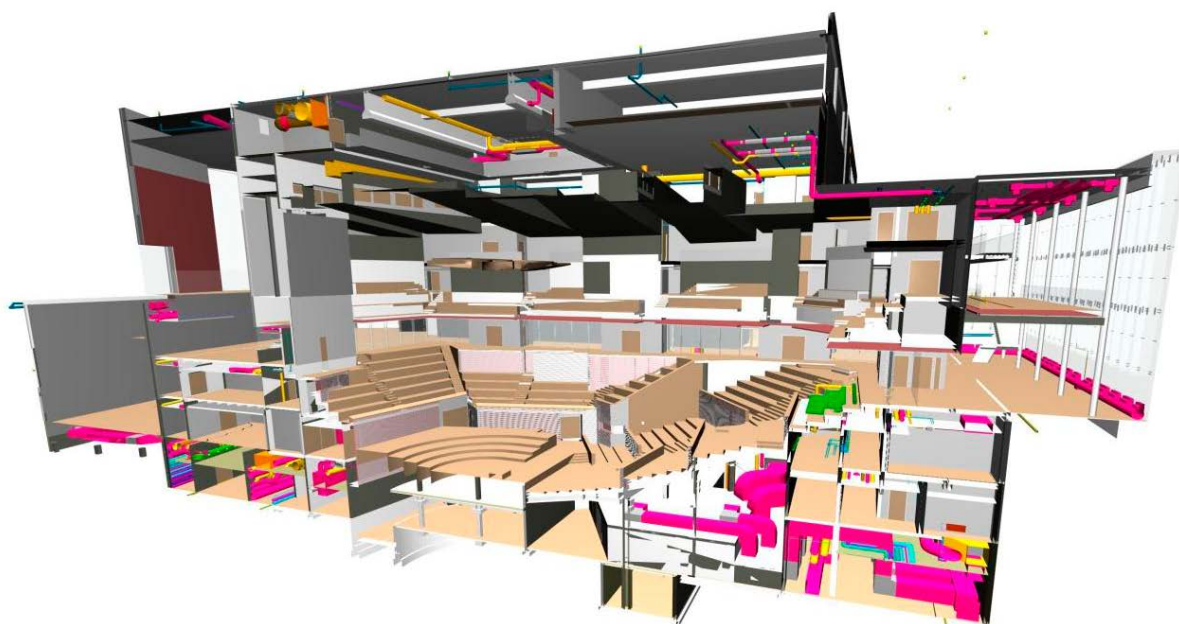
Рисунок 14 — Пример технической иллюстрации. В объединенной электронной модели показаны строительные элементы различных дисциплин. Цвета и поверхностные материалы являются чисто символическими и служат для технического проектного анализа
