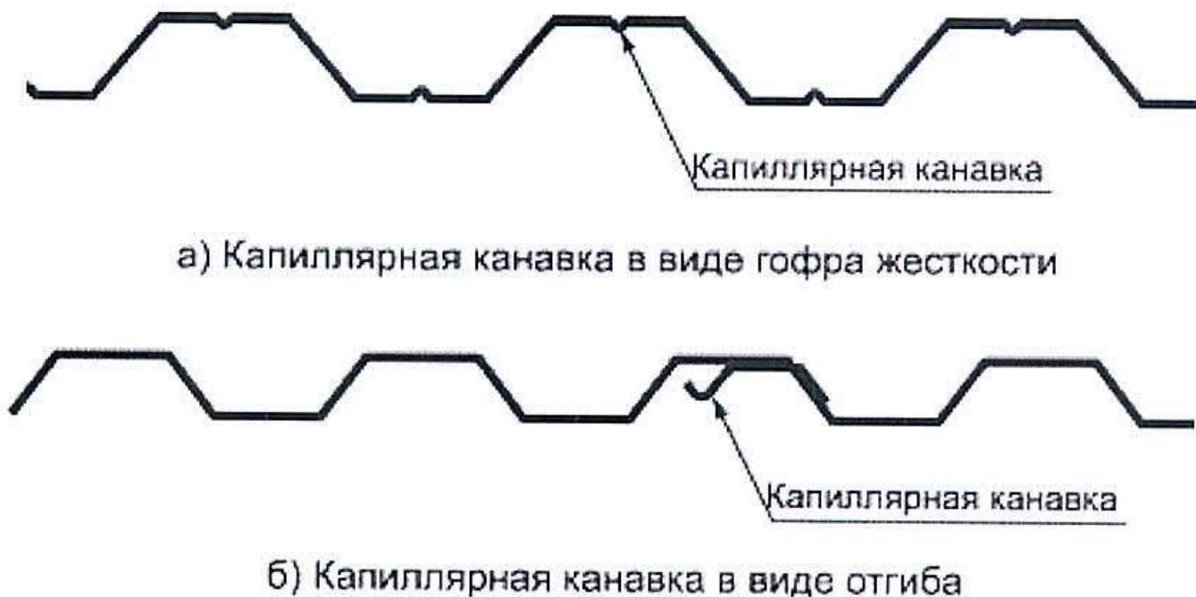
Рисунок 3 – Основные виды капиллярных канавок
