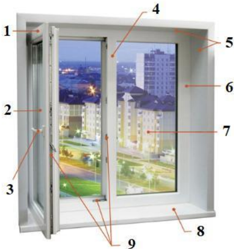
1 – створка, 2 и 7 – стеклопакет, 3 и 9 – фурнитура, 4 – импост, 5 – откосы, 6 – рама, 8 – подоконник.
