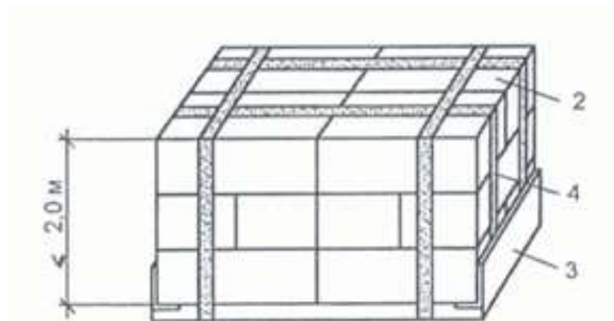
Рисунок 1.1 - Схема размещения блоков из ячеистого бетона на поддоне
