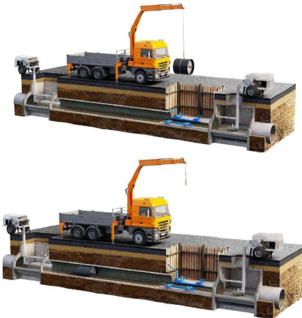
Рисунок 2.6 - Процесс калибровки участка трубы
