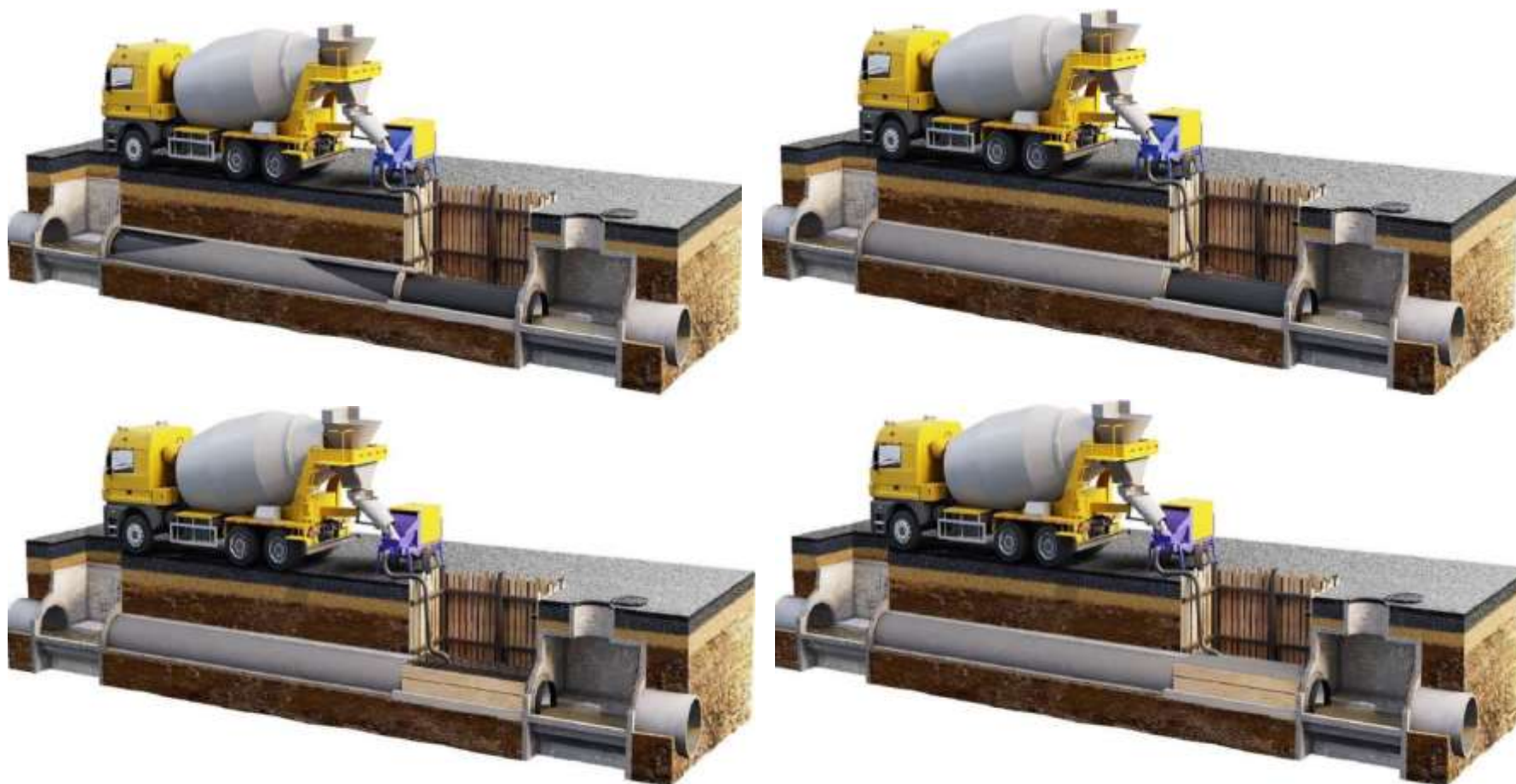
Рисунок 2.10 - Тампонирование межтрубного пространства и свода коллектора
