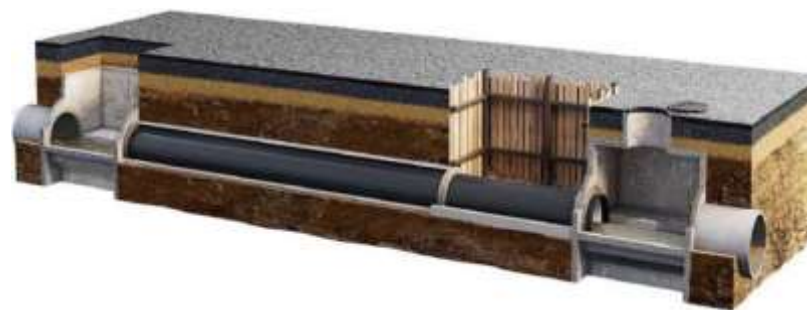
Рисунок 2.8 - Протяжка резьбовых модулей (труб) типа СПИРОЛАЙН при помощи кондуктора
