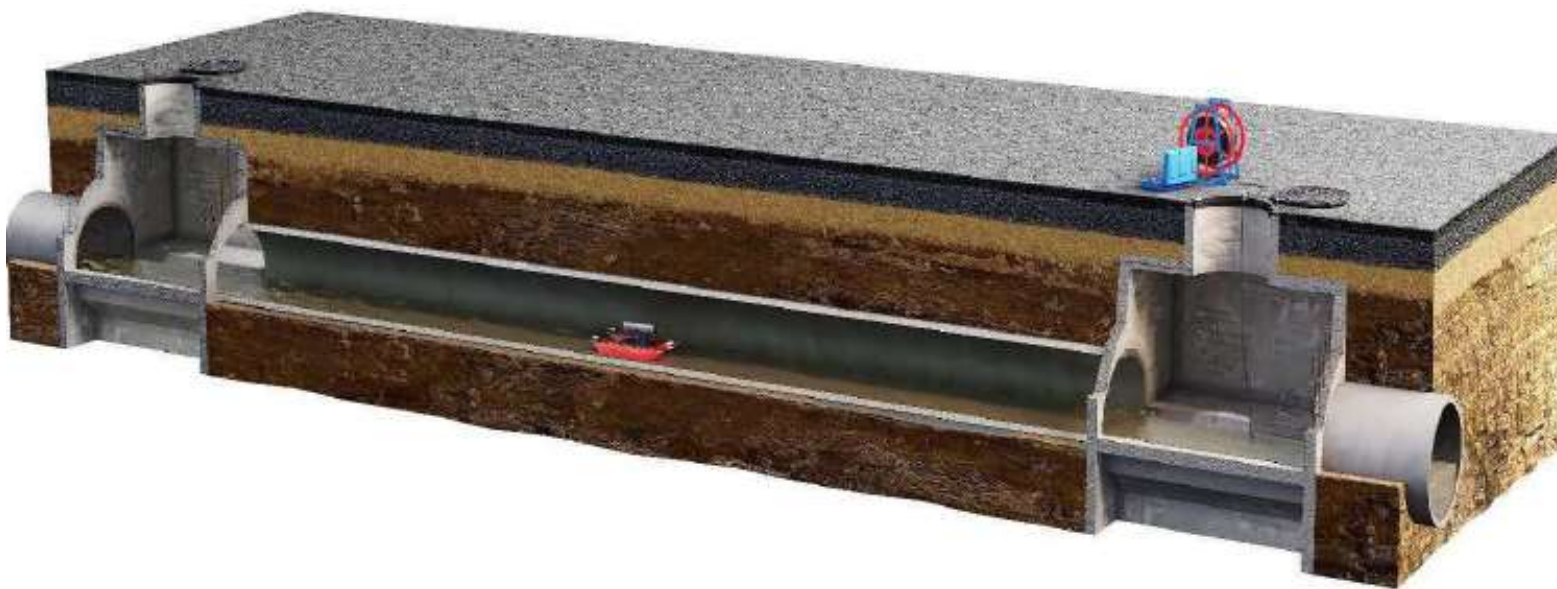
Рисунок 2.4 – Телеинспекция робототехническим оборудованием
