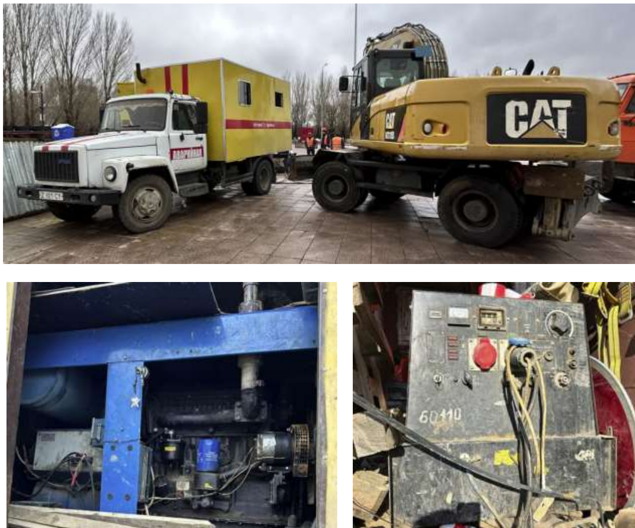
Рисунок 1.7 - Аварийно-ремонтная машина на базе ГАЗ и колесный экскаватор M318D
