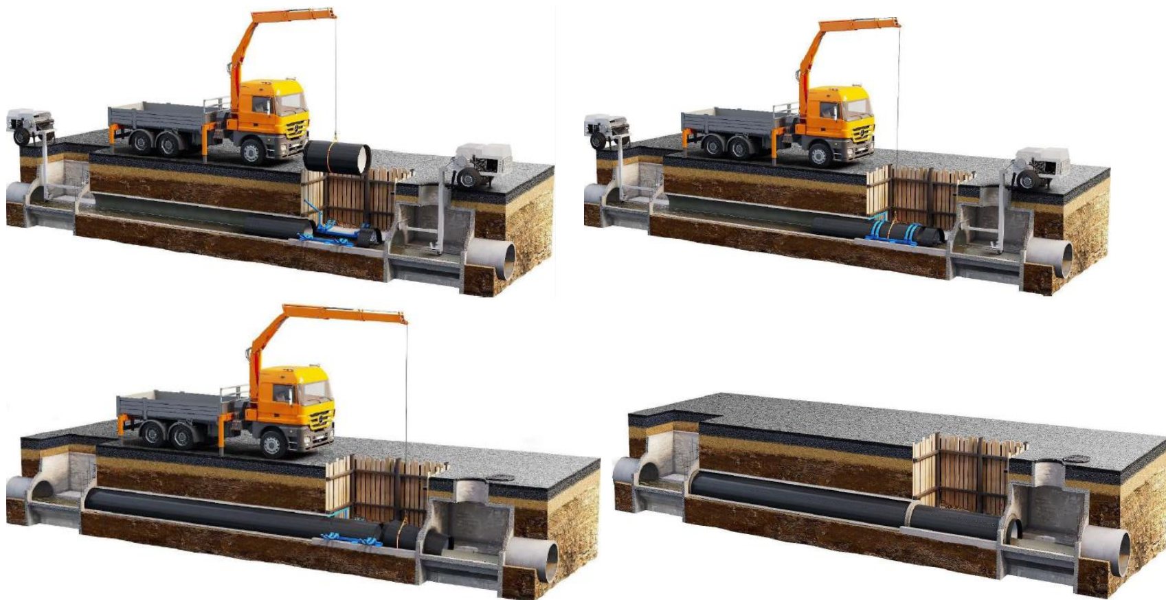
2.8-сурет - СПИРОЛАЙН типті бұрандалы модульдерді (құбырларды) кондуктордың көмегімен тарту
