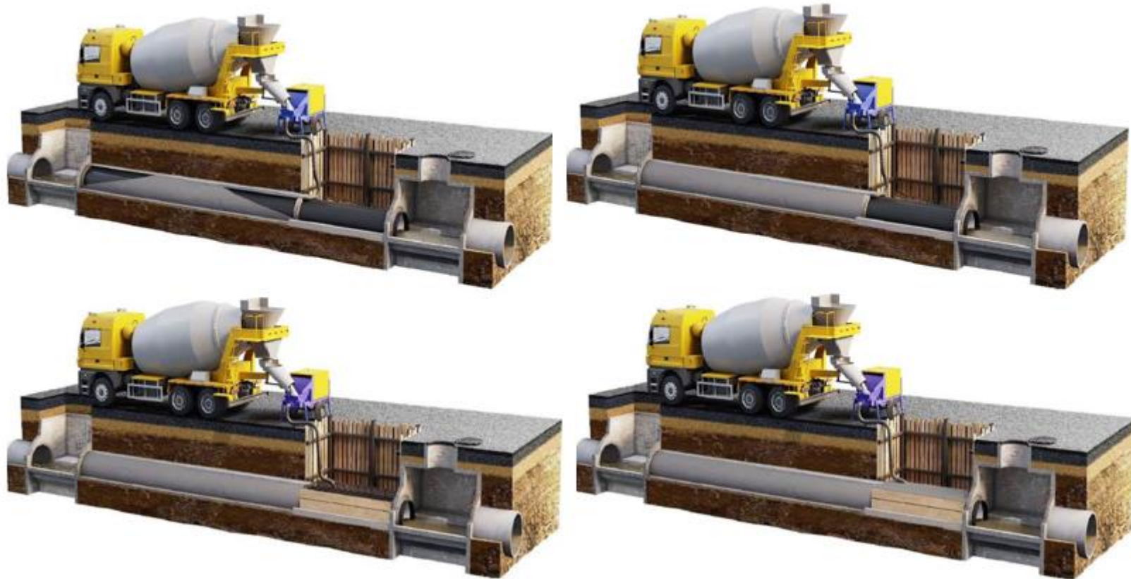
2.10-сурет - Құбыраралық кеңістікті және коллектор тоғыспасын тығындау
