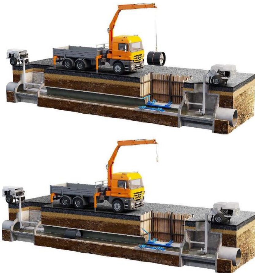
2.6-сурет - Құбыр учаскесін калибрлеу процесі
