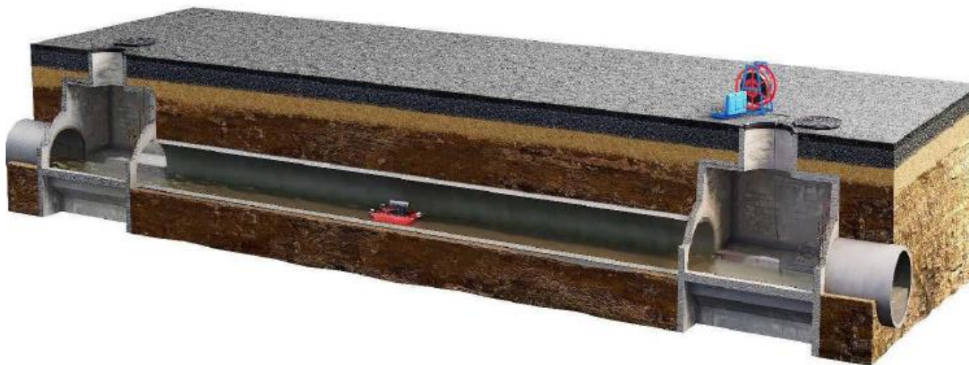
2.4-сурет – Робототехникалық жабдықпен телеинспекция
