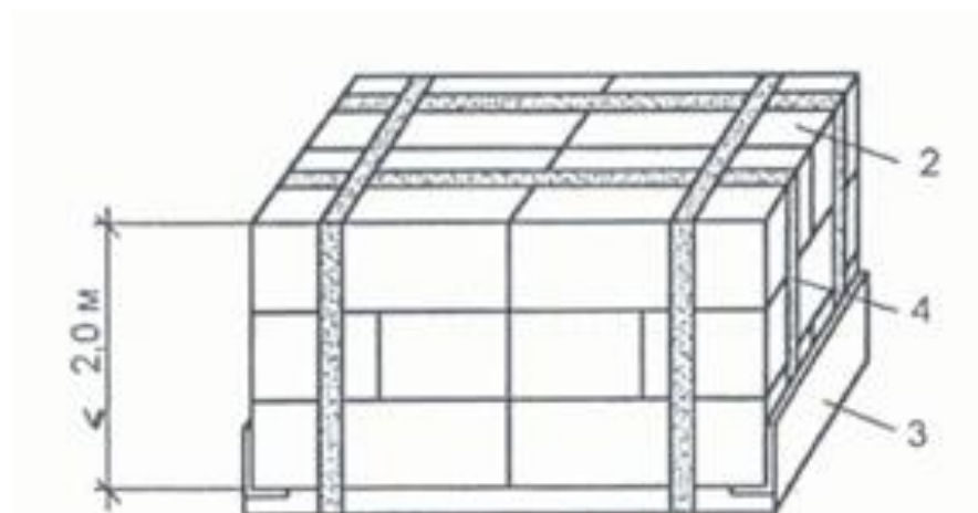
1.1-сурет – Тұғырықтағы қуыс бетоннан жасалған блоктарды орналастыру схемасы 1 - қуыс бетоннан жасалған блоктар; 2 - МЕМСТ 3560 бойынша болат таспа; 3 - тұғырық
