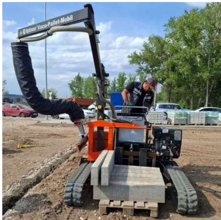
2 сурет – Бордюр тастарын төсеуге арналған өздігінен жүретін машина
