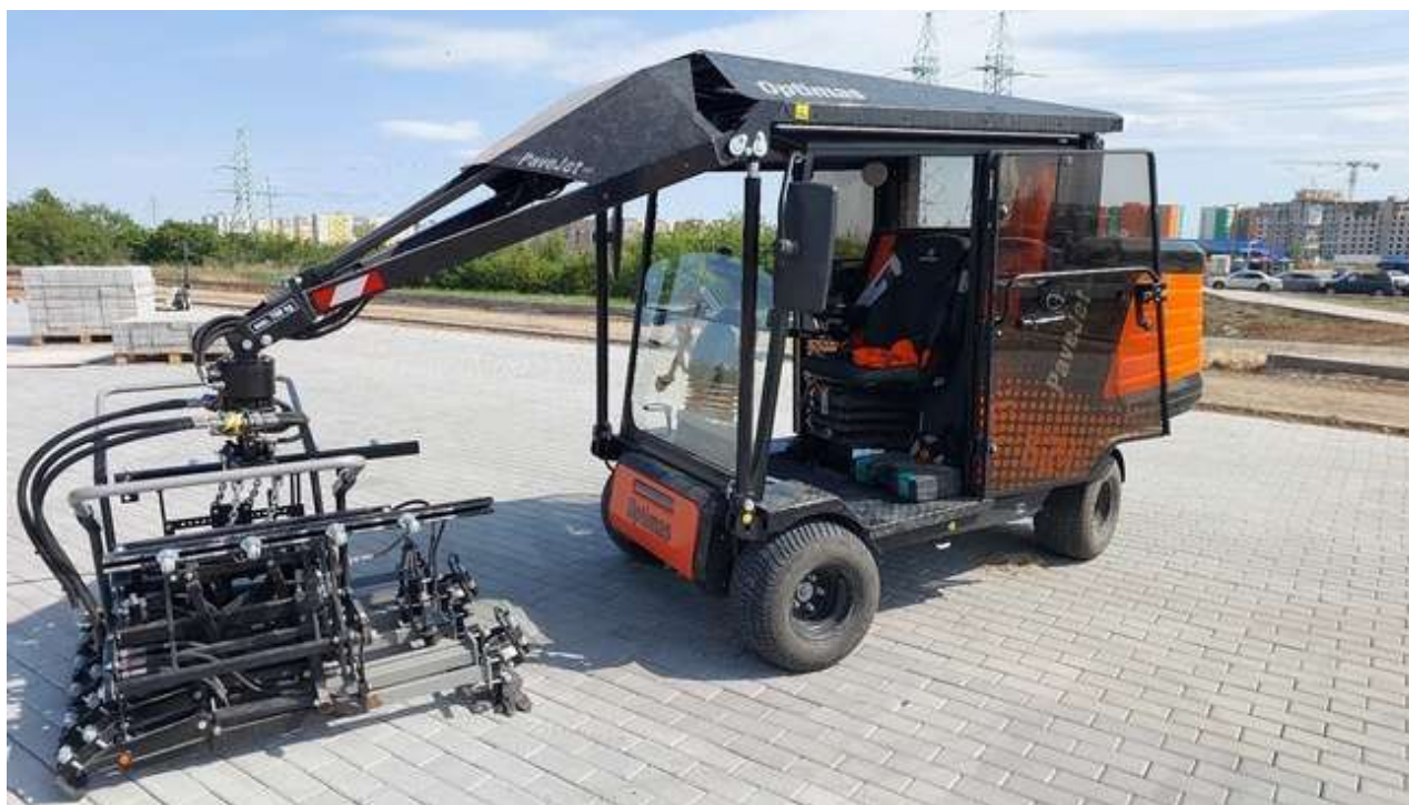
3 сурет – Тротуар плиткаларын төсеуге арналған өзі жүретін машинаның жалпы көрінісі
