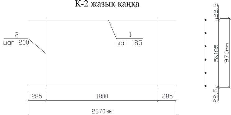
Л.19-сурет – Қалыпты блоктың қалыптық және арматуралық сызбалары
