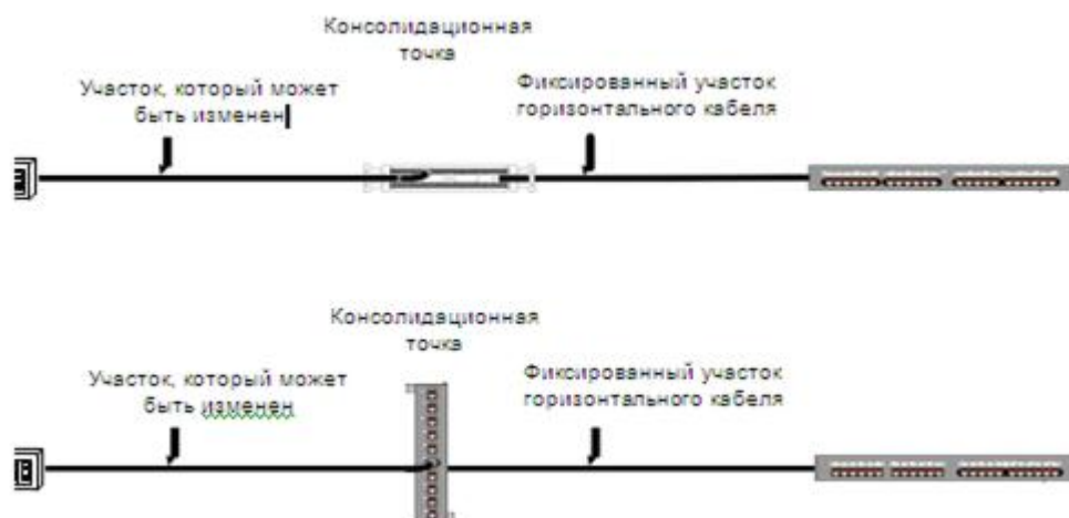
Рис. 7.16 Пример использования консолидационных точек в кабельных линиях с витой парой
