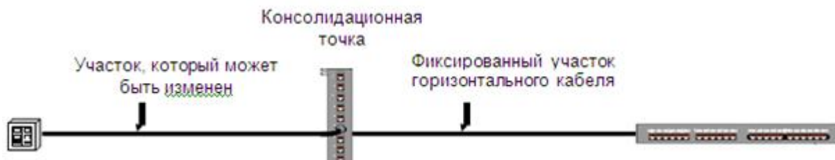
Рис. 6.9 Пример реализации консолидационной точки
