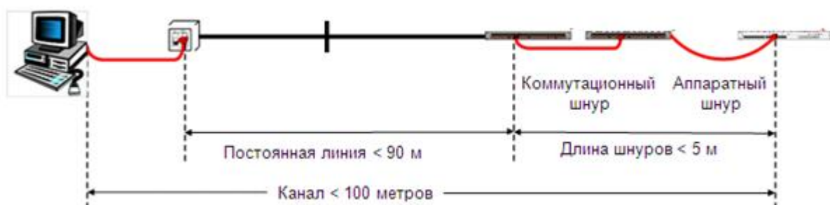
Рис.7.13 Максимально допустимая длина коммутационных и аппаратных шнуров и перемычек
