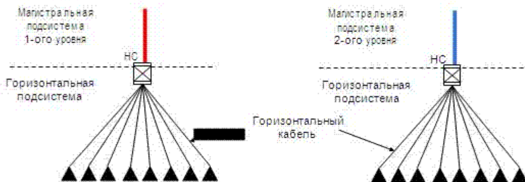
Рис.6.5 Примеры горизонтальных кроссов
