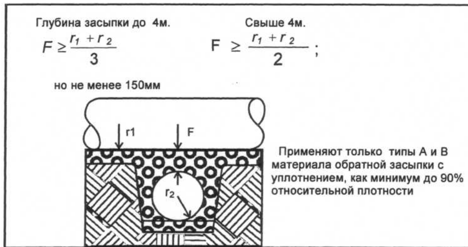
Рисунок 14.2 - Пересечение трубопроводов
