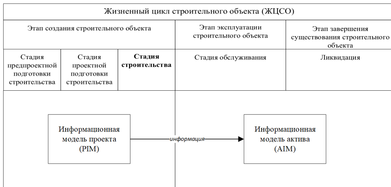
Рисунок 1 – Схема информационной модели строительного объекта
