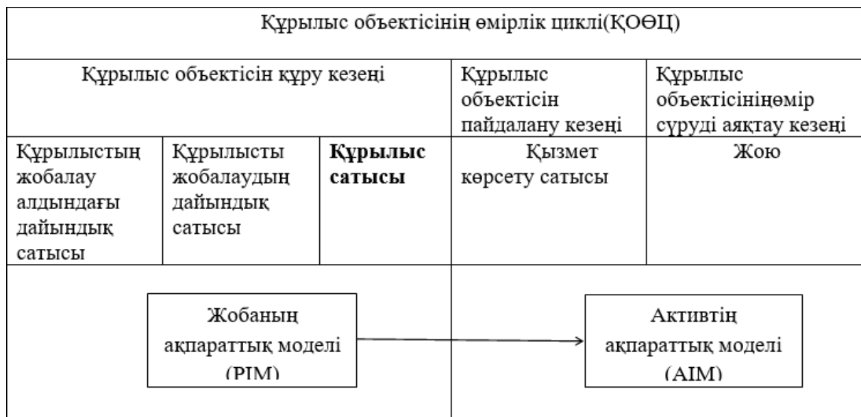
1-сурет. Құрылыс объектісінің ақпараттық моделінің сызбасы
