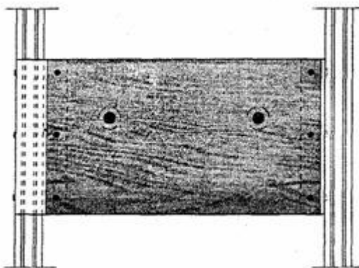
Рисунок 19 - Универсальная деревянная траверса
